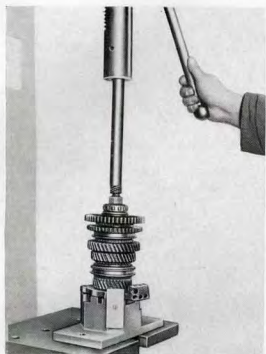
Kuva G 101 Kartiopyöräkselin erillisiosien puristaminen
