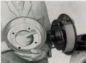
Kuva F 79. Jarrurummun keskitysreunus ja laippapinta voidellaan kevyesti rasvalla
