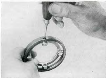
Kuva G 38 ja G 39. Jousien ja kuulien asentaminen liukunastoihin asennusrenkaan avulla
