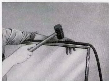
Kuva K 20. Tiivistyskumin asentaminen kehykseen kumivasaran avulla
