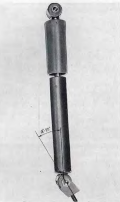
Kuva F 53. Etuiskunvaimentimen kiinnittimen asennus
