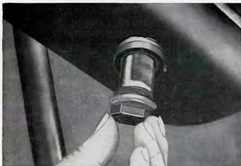
Kuva M 54. Nousuputken suodattimen esilleotto
