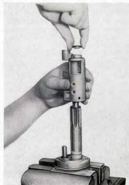
Kuva F 22. Hammaspyörän laakerin asentaminen
