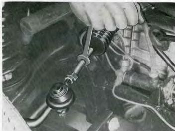
Kuva F 30. Raidetangon säätäminen
