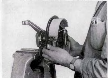
Kuva F 47. Etujarrujen asettaminen laakerille 6307
