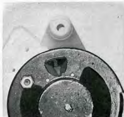
Kuva M 70. Latausgeneraattorin hiilien tarkastus
