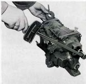
Kuva G 92. Takimaisen pääakselin kuusikantamutterin irroitus ja kiinnitys
