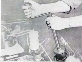
Kuva F 31. Etujousen puristaminen laitteella W-230 022/1
