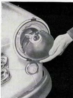
Kuva E 1 Etulyhdyn sisäosan irrottaminen (epäsymmetrinen)
