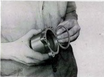
Kuva F 46. Tasauslevyn asettaminen pyörännapaan
