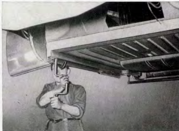
Kuva K 1. Korin kumityynyn kiinnitys
