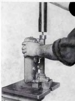
Kuva M 29 Kuulalaakerin painaminen ulos vesipumpun puolelta
