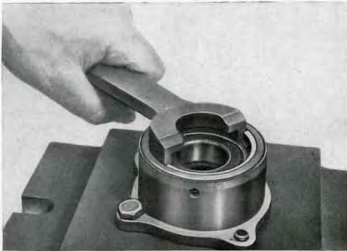
Kuva G 35. Laippaholkin rengasmutterin irroittaminen
