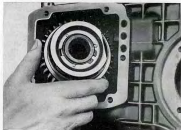
Kuva G 54. Sivuakselin asentaminen
