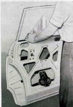
Kuva K 5. Takaoven ikkunan ja kampikoneiston irroitus
