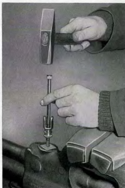
Kuva F 12. Vaihdevivun kokoaminen
