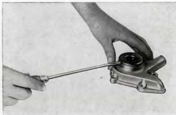
Kuva M 31. Pumppukotelon kannen irroittaminen
