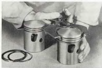
Kuva M 17. Männänrenkaan irroitus ja kiinnitys männänengaspihdeillä
