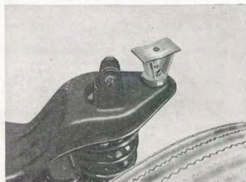
Kuva F 99. Korin takaosan kiinnitys, rakennesarja 312
