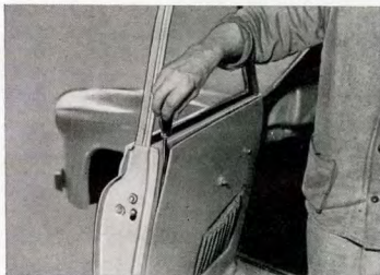
Kuva K 2. Sisäverhouksen pehmustehakasten irroitus
