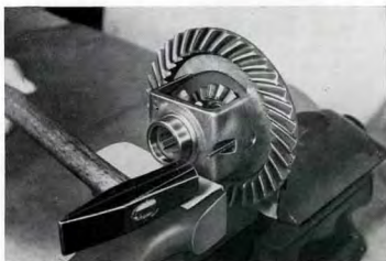
Kuva G 47. Kartiosokka lyödään paikalleen
