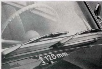
Kuva E 18. Suuttimen kiinnitys moottorinsuojukseen
