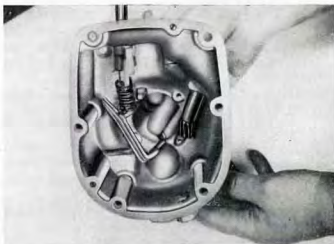
Kuva G 82 Vapaakytkimen lukitushaarukan asentaminen
