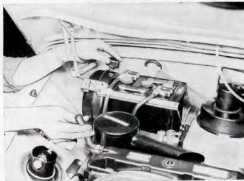
Kuva M 80. Yhdysletkun kiinnipuristaminen
