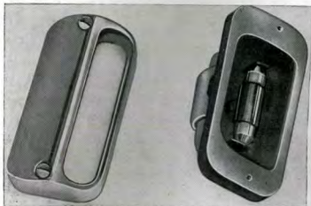
Kuva E 28. Numerokilven valaisin irroitettuna
