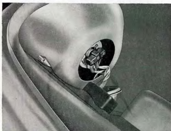
Kuva E 24. Lampun vaihto etulyhtyyn
