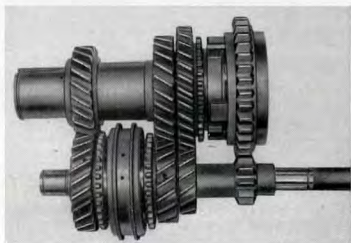
Kuva G 7. Vaihdepyörien asento 1. vaihteella
