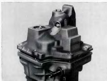
Kuva G 126. Takimaisen vaihteistonkotelon asennus
