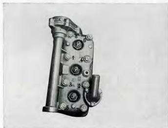
Kuva M 40 Sylinterinkannen muttereiden kiristysjärjestys
