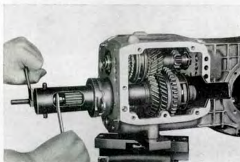
Kuva G 67 Silmäholkin painaminen asennuslaitteella W-86 914 1
