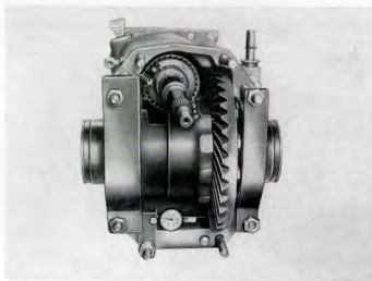
Kuva G 129. Lautaspyörän hammasvälyksen säätäminen
