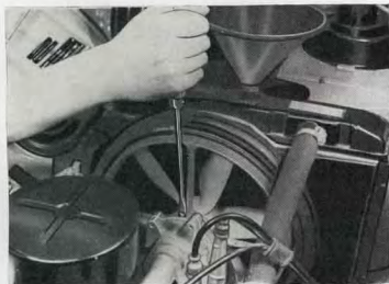
Kuva M 77. Ilmanpoisto vesipumpusta
