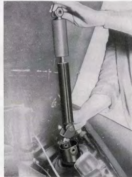
Kuva F 55. Etuiskunvaimentimen asennus
