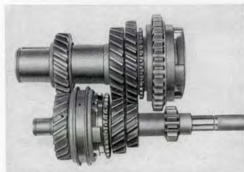
Kuva G 10. Vaihdepyörien asento 4. vaihteella
