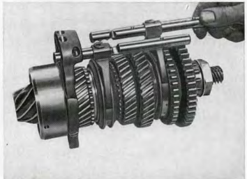
Kuva G 110. Peruutusvaihteen siirtoakselin asennus
