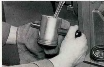
Kuva M 20. Männäntapin ohjaaminen erikoistuurnalla
