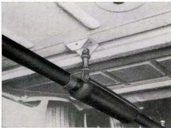
Kuva F 96. Lisävaimentimen elastinen kiinnitys
