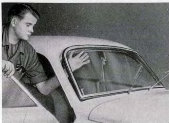
Kuva K 16. Tuulilasin painaminen irti korista
