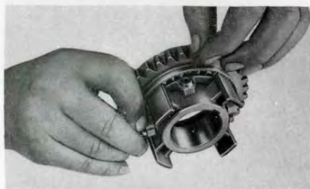
Kuva G 38 ja G 39. Jousien ja kuulien asentaminen liukunastoihin asennusrenkaan avulla
