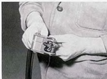
Kuva K 17. Tuulilasin tiivistyskumin kiinnittäminen vetolaitteeseen CSK 5987
