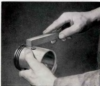
Kuva M 18. Lievästi kiinnileikanneen männän käsitteily bensiini-öljy-sekoitukseen kostutetulla korundikivellä
