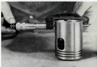
Kuva M 16 Männän halkaisijan mittaaminen alahelmasta
