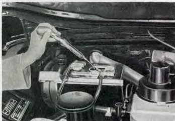
Kuva M 67. Hapon ominaispainon mittaaminen
