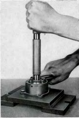
Kuva G 34. Kartiopyöräkselin uramutterin irroittaminen haka-avaimella W-86 961/1
