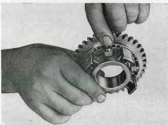
Kuva G 40 ja G 41. Jousien ja kuulien asentaminen liukunastoihin ilman asennusrenkasta
