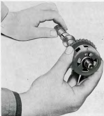
Kuva G 113. Kehikon asentaminen jousineen
