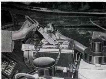
Kuva M 68. Akun jännitteen mittaaminen
