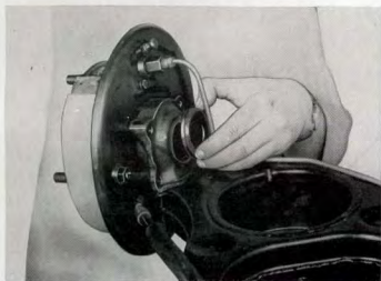
Kuva F 78. Laakerilaipan aukko suljetaan kumitulpalla
