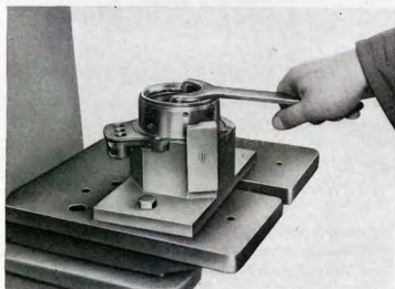
Kuva G 103 Laippaholkin rengasmutterin irroitus ja kiinnitys
