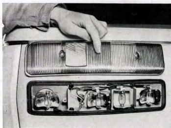
Kuva E 27. Takalyhty valonlähäpääsylevy irroitettuna
