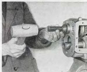
Kuva G 65. Kuulalaakerin 6304 asentaminen
