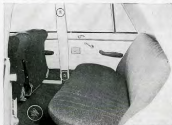
Kuva K 41. Turvavyöiden kiinnitys
