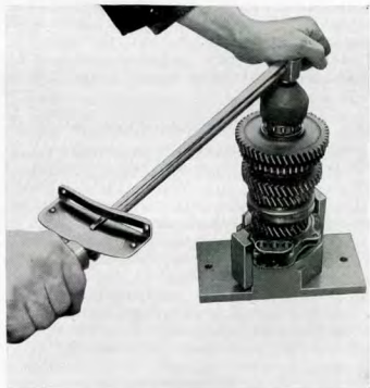
Kuva G 100. Kuusikantamutteri M 30 × 1,5 irroitetaan ja kiinnitetään pidätinlaitteella
